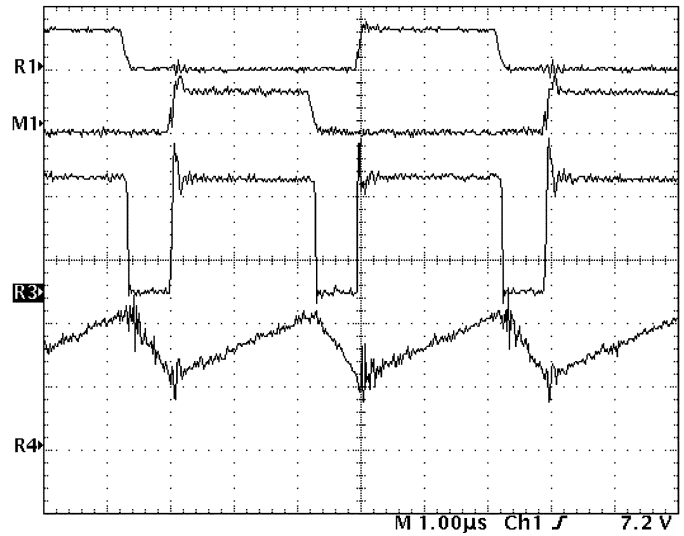
Fig. 16. Mode 1 ( V_i = 70 V), R1: Vgs1, 20 V/Div, M1: Vgs2, 20 V/Div, R3: V_{bus} , 20 V/Div, R4: IL, 8 A/Div.
